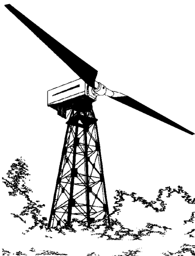
Fig V.7.- Aerogenerador experimental MOD-0A de 200 kW
