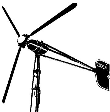
Fig V.1.- Aerogenerador Jacobs de 1 kW
